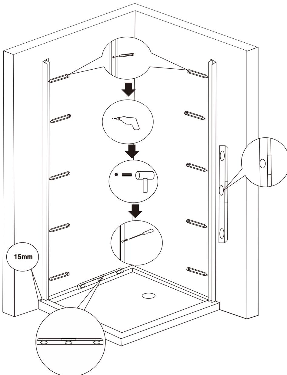
1. Setzen Sie nun die zwei feststehenden Glaselemente in die Wandprofile ein.
