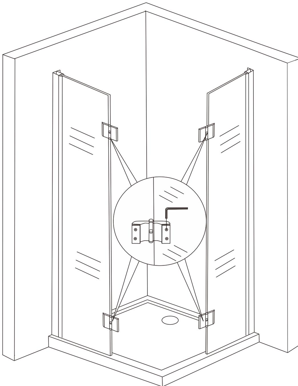
1. Bevor Sie die Duschtür einsetzen, bringen Sie die Duschdichtung unter der Duschtür an
