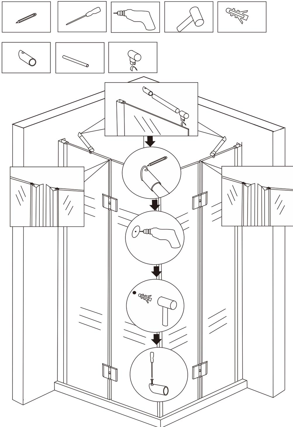
1. Setzen Sie die Kappen auf die Aluminiumprofile
