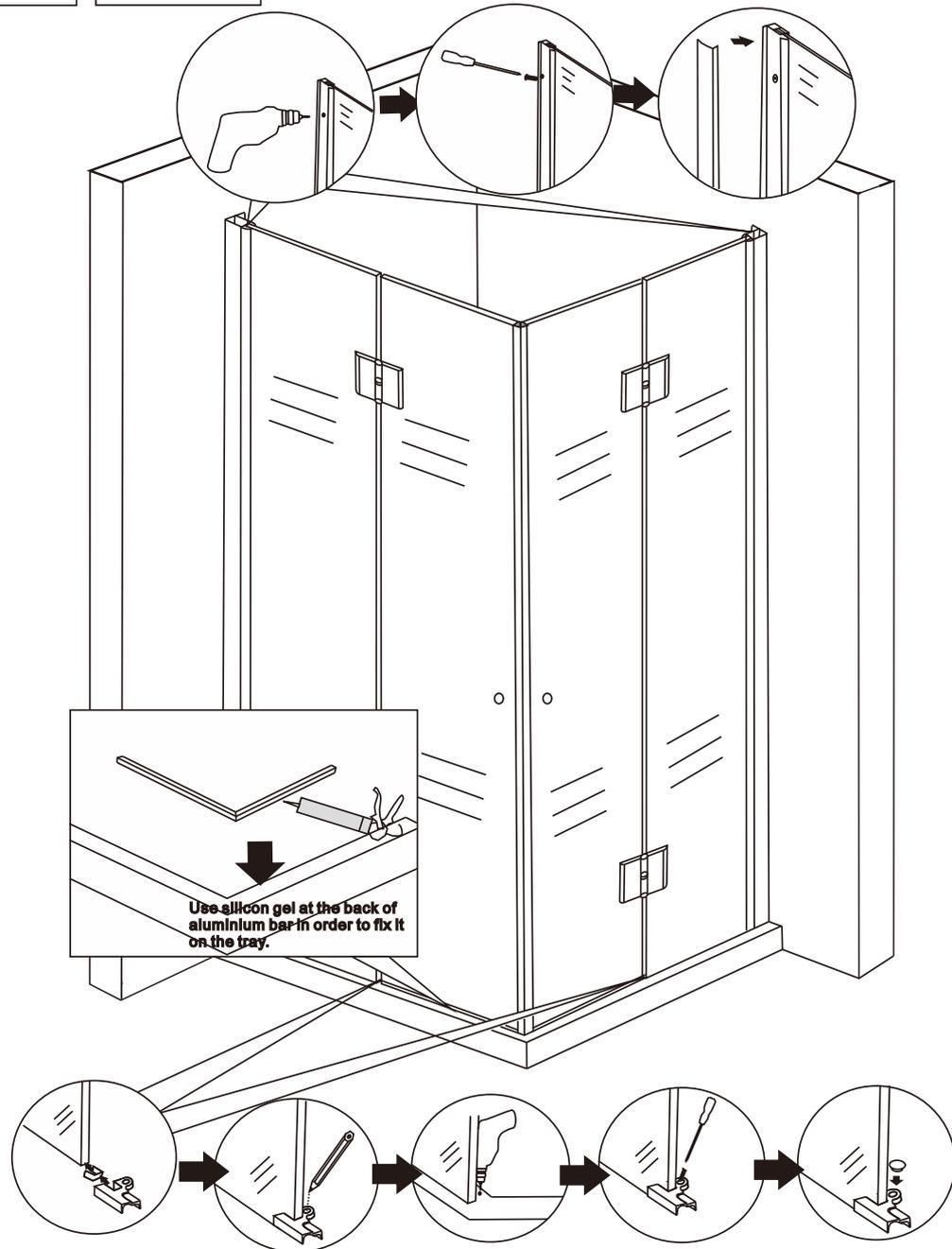
1. Installieren Sie als nächstes die Stabilisationsstangen an die Wand. Warten Sie noch mit der Befestigung an den Scheiben. Da Sie noch die Duschkabine justieren müssen.
